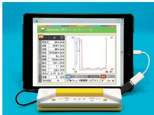
NHK for School「10min.ボックス テイクテック」でセンサ・コンピュータ・アクチュエータの仕組みを知って **AkaDako** 探究ツールの様々なセンサーを体験。
