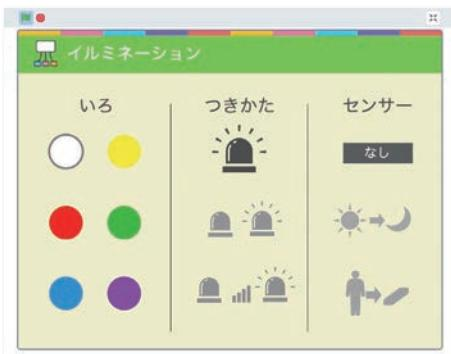
画面をクリックするだけで様々な演出ができます。センサーで明るさを指定し、暗幕カーテンを閉めて教室の電気を消すと、一斉点灯させることができます。
