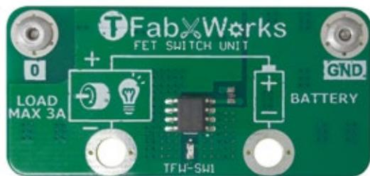
豆球・LED・モーター等の電源 OFF/ON が micro:bit のプログラムから簡単に制御が出来ます。配線は既存で動いている回路の間に挟むだけ。あとは、プログラム側でデジタルで P0 に 1 を書けば ON、P0 に 0 を書けば OFF になります。
